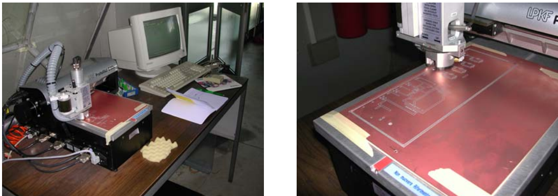
Figura 14: LPKF Protomat C30s al lavoro
