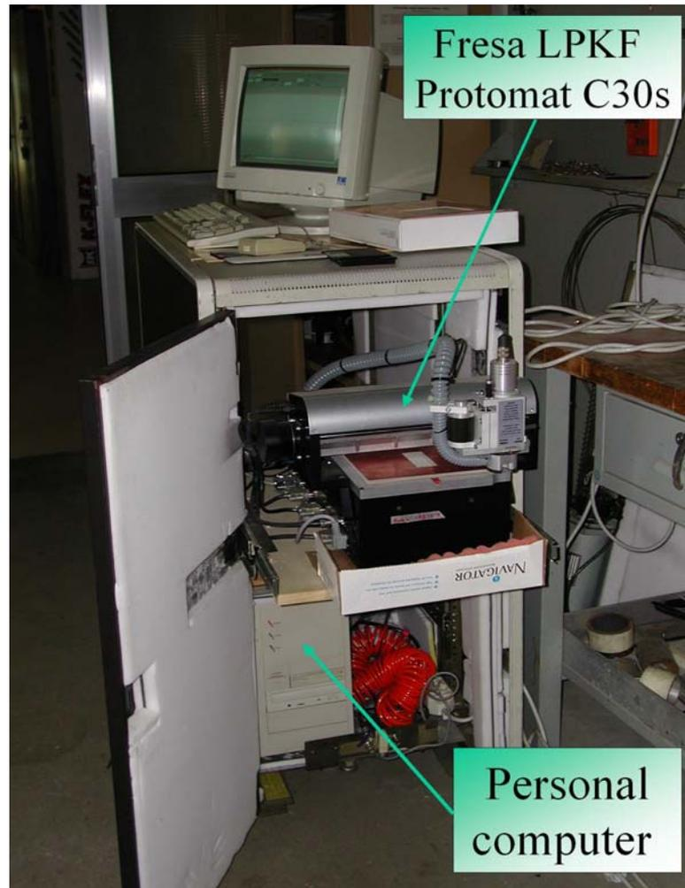
**Figura 2.9: Sistema composto da Personal Computer e fresa**
