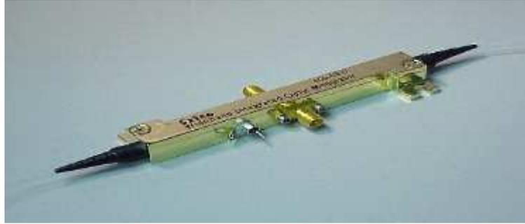
**Figura 4.2.1.2** – Foto di un tipico modulatore esterno MZI
