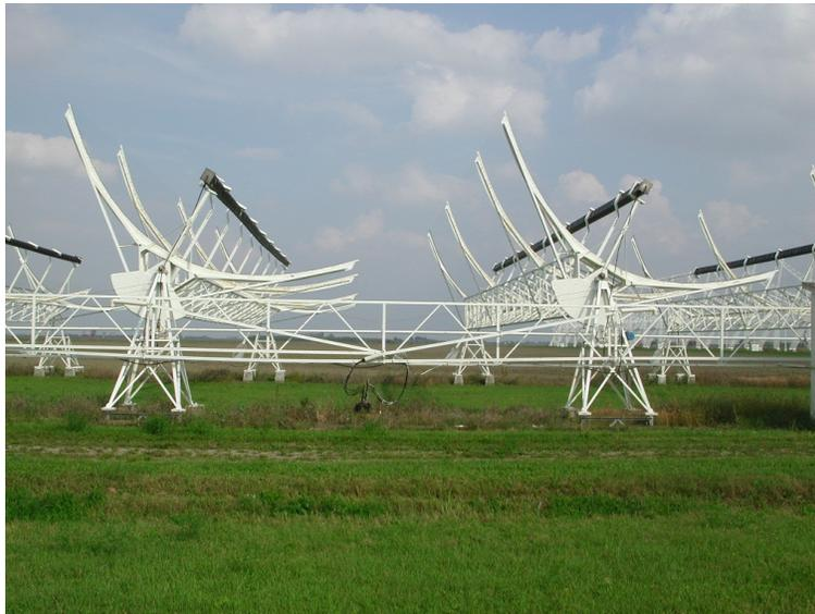
Figura 1.3: Particolare con 2 delle 64 antenne cilindro-paraboliche che costituiscono il ramo N-S della *Croce del Nord*.
