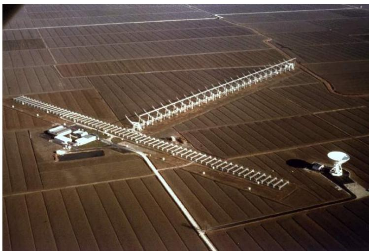
Figura 1.1: Veduta aerea della *Croce del Nord*. Si scorge a lato l'antenna parabolica da 32m di diametro usata per le osservazioni in rete VLBI (*Very Long Baseline Interferometry*).
